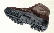
Solado Constituído de duas camadas de poliuretano (PU), injetado diretamente no cabedal, sendo a 1ª camada (entressola) mais macia e leve, com densidade de 0,4g/cm³ proporcionando maior conforto; e 2ª camada (sola) mais compacta com densidade de 1,0 g/cm³, resistente a abrasão com sistema antiderrapante constituído de ranhuras especiais de 3mm de altura e 6mm de largura e resistencia ao escorregamento em piso cerâmico e piso de aço (Nível SRC).
